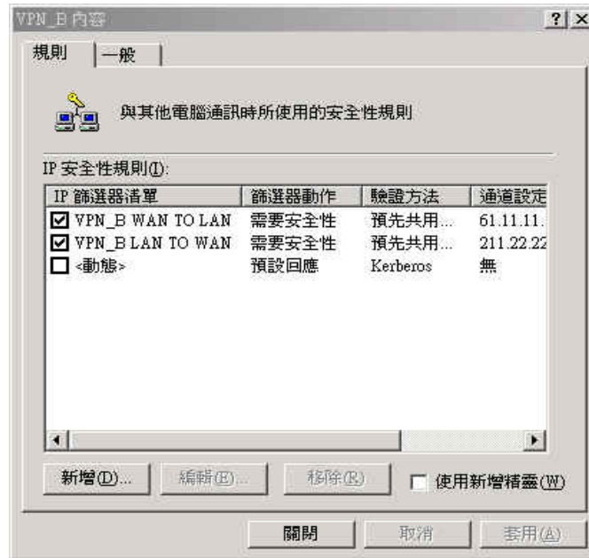
圖 11-91 完成 VPN_B LAN TO WAN 規則設定
