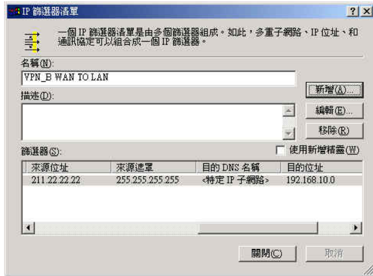
圖 11-64 完成 IP 篩選器設定
